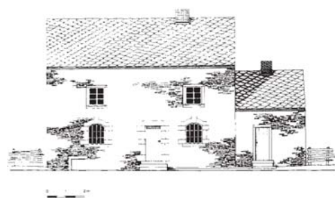
Plan et élévation d'un logis de Ortho du dernier quart du 18ème siècle. A noter, la cuisine dessert toutes les pièces, y compris l'escalier de la cave. Source : Ardenne centrale, Mardaga, 1987
